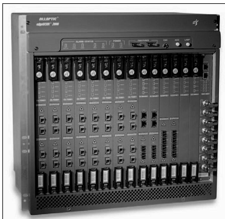
Rys. 14. Urządzenie centralowe Alloptic Edge2000 mieszczące 16 OLT dla sieci GE-PON. [24]
